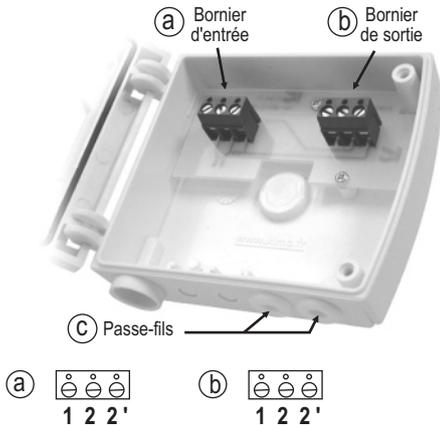
(C) Passe-fils : pour insérer un câble, il est nécessaire de faire une petite entaille avec un objet pointu dans la membrane de caoutchouc.
