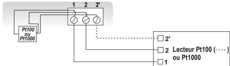
\* Le raccordement d'une Pt100 s'effectue généralement en 3 fils, le troisième fil servant à la compensation de la résistance des câbles de raccordement.
