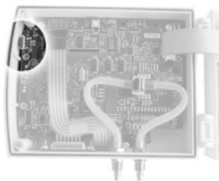
Un interrupteur situé en haut à gauche du capteur (ouvert) permet de choisir la sortie analogique 0-10V ou 4-20 mA
