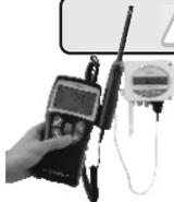
L'EHK 500 est un appareil portable étalon (option) vous permettant d'effectuer l'ajustage en humidité et en température via une simple liaison RS232. Ce nouveau procédé vous fera gagner du temps : il ne sera pas nécessaire de nous retourner le capteur pour effectuer un ajustage en humidité et en température.
